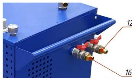
Рисунок 8. Шаровые краны для слива излишков рабочей жидкости, выравнивания давления с атмосферным и удаления вспененной СОЖ.
