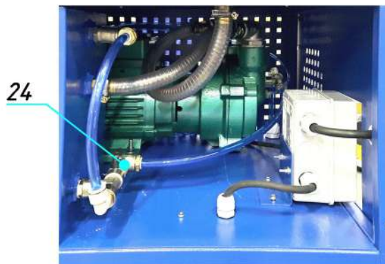
Рисунок 10. Шаровой кран первичного водяного контура затопления помпы.
