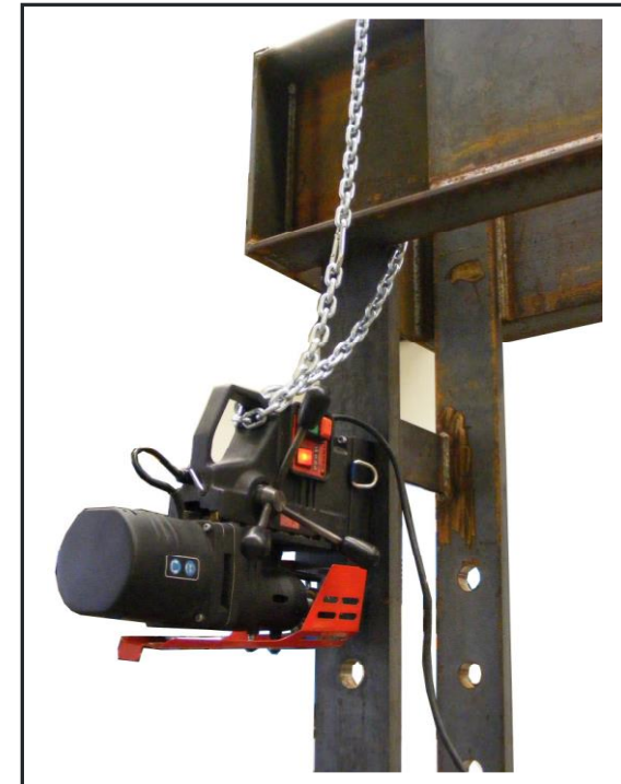
Рис.4 Пример использования страховочной цепи
