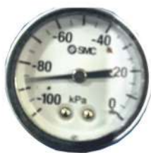
Рисунок 19. Показания вакуумметра после окончания регулировки.
