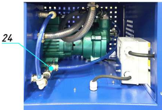
Рисунок 10. Шаровой кран первичного водяного контура затопления помпы.
