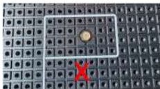
Область уплотнения не соответствует требованиям. Слишком мал для заготовки.
