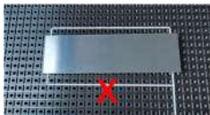
Область уплотнения не соответствует требованиям. Слишком большой для заготовки.
